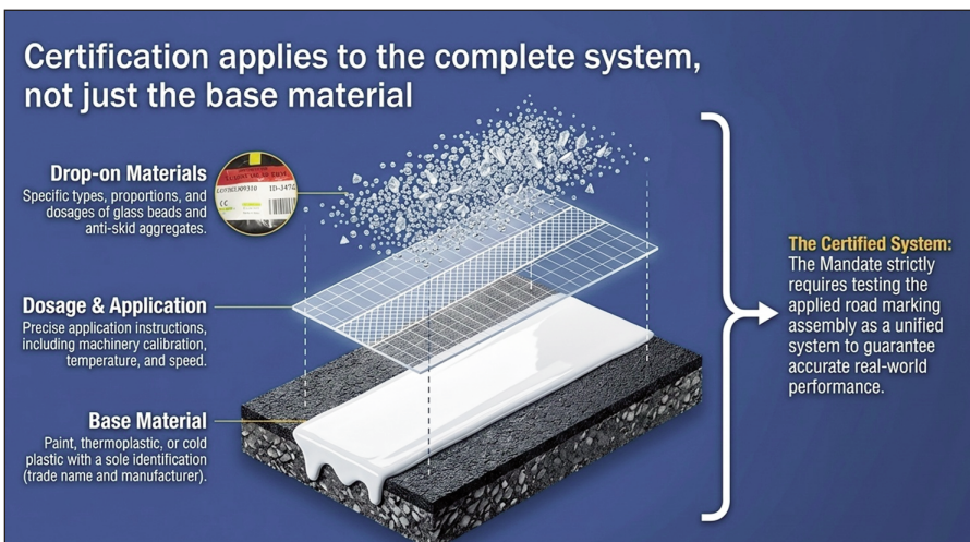
Ilustración 3: Una marca vial es el producto final, ya aplicado en carretera, que incluye el material base y material de postmezclado, en su caso, con la dosificación de cada uno de ellos y el modo de aplicación.
